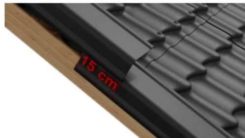
Presah štítových lišt min. 15 cm
