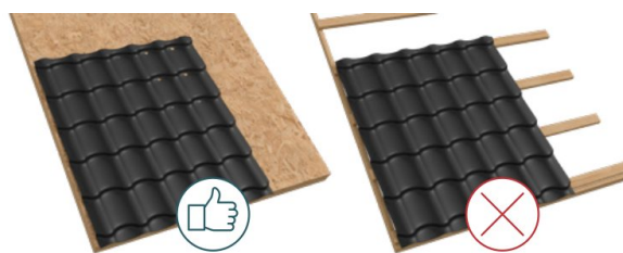
Vľavo správne: celoplošné debnenie · vpravo nesprávne: laty
