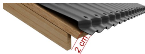
Presah nad odkvapom max. 2 cm
