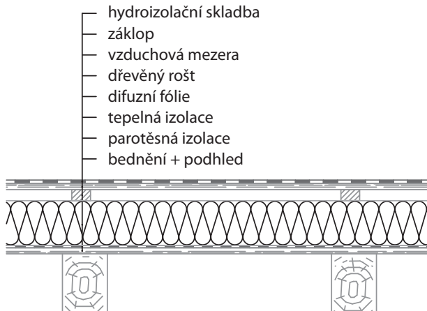
Obr. č. 7 - Dvouplášťová střecha s viditelnými trámy.
